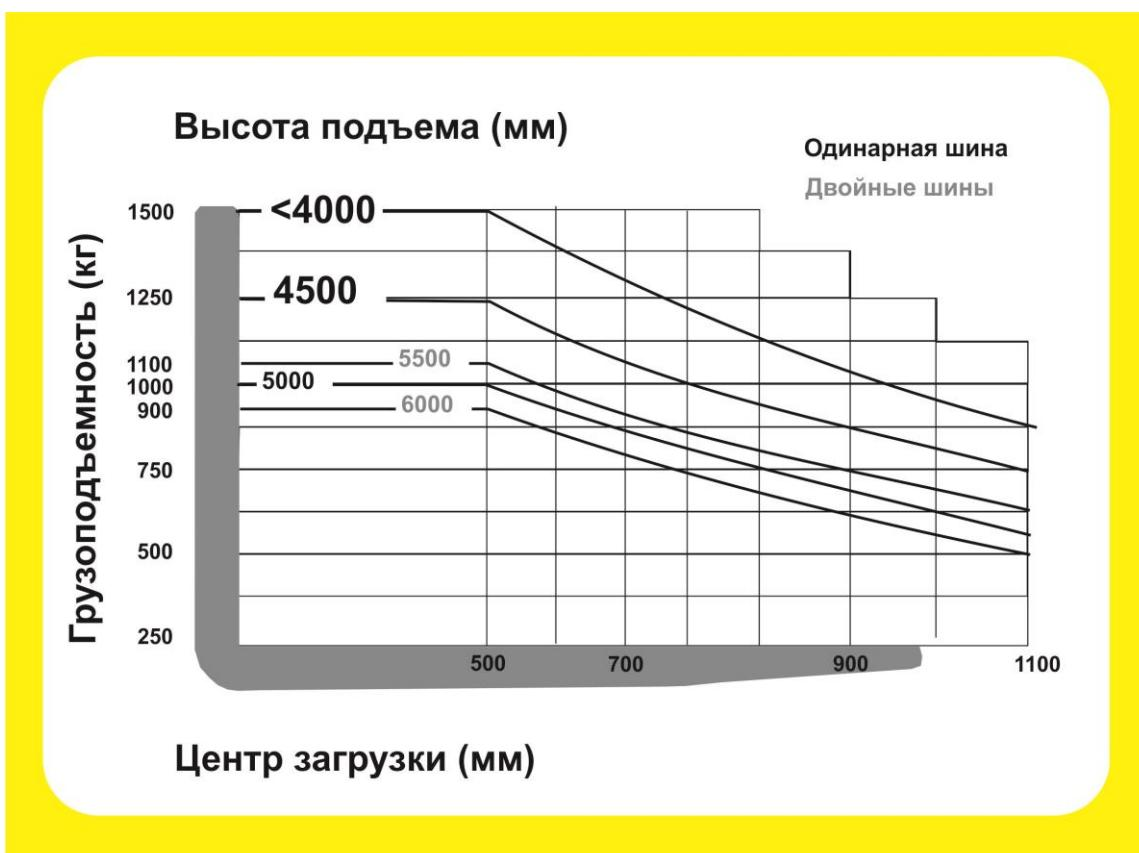
У погрузчика с мачтой высотой 4500 мм фактическая грузоподъемность будет меньше 1250 кг его номинальной грузоподъемности, если центр загрузки удален от спинок вил на 700 мм. Чтобы определить по графику фактическую грузоподъемность при расстоянии до центра загрузки в 700 мм, следует от места пересечения вертикали, идущей от отметки 700 мм на шкале расстояния до центра загрузки, с кривой, соответствующей высоте подъема на 4500 мм, провести горизонталь к шкале грузоподъемности.
