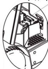
Панель с плавкими предохранителями
